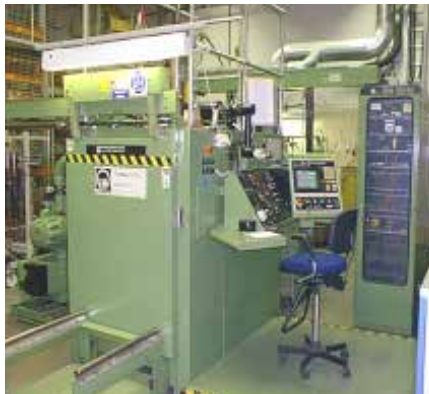
VTT:lle hankittiin v. 1986 15 kW:n EB-hitsauslaite, jonka käyttö on ollut pitkäikäisintä Suomessa. © VTT.
