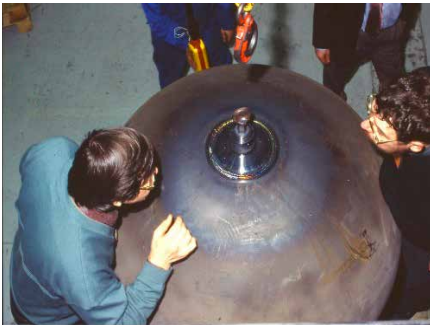
HITSI 2000 -projektissa (v. 1995) testattiin EB-hitsauksen soveltuvuutta RAEX-hienoraeteräksisen kaasupallon valmistukseen. Hitsin kovuusarvojen alentamiseksi liitosympäristö esilämmitettiin EB-säteellä ennen hitsausta. © I. Meuronen.
