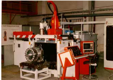
VTT:lle hankittiin v. 1986 15 kW:n EB-hitsauslaite, jonka käyttö on ollut pitkäikäisintä Suomessa. © VTT.
